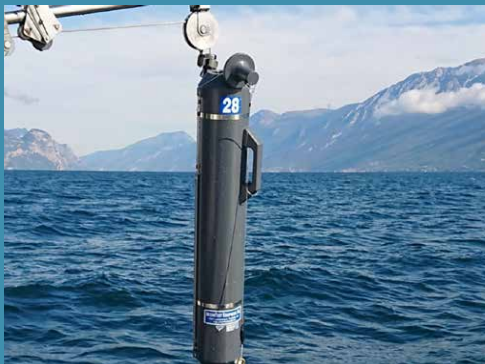
Bottiglia di prelievo "Niskin" utilizzata per la raccolta di campioni di acqua dalla superficie al fondo (350 m) del Lago di Garda
